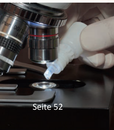
Aufbringen des Immersionsöl auf Dunkelfeld Kondensor
